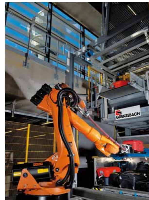
Im Bereich der Intralogistik werden mit Grenzebach Robotic Gepäckstücke automatisch verladen (Bild 1) sowie Paletten optimal be- und entladen (Bild 2). Quelle: Grenzebach
