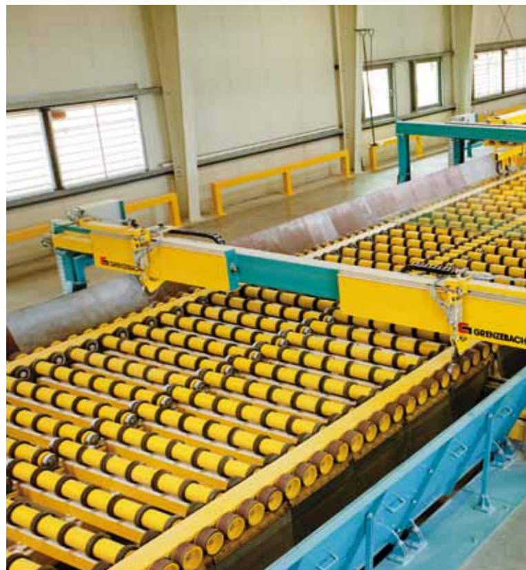
Prozessgesteuerte Materialfluss- und Handlingsanlagen in der Flachglasindustrie ermöglichen höchste Präzision und Laufruhe bei Produktion, Verarbeitung sowie Transport von Glas und machen Grenzebach zu einem richtungsweisenden Unternehmen. Quelle: Grenzebach
