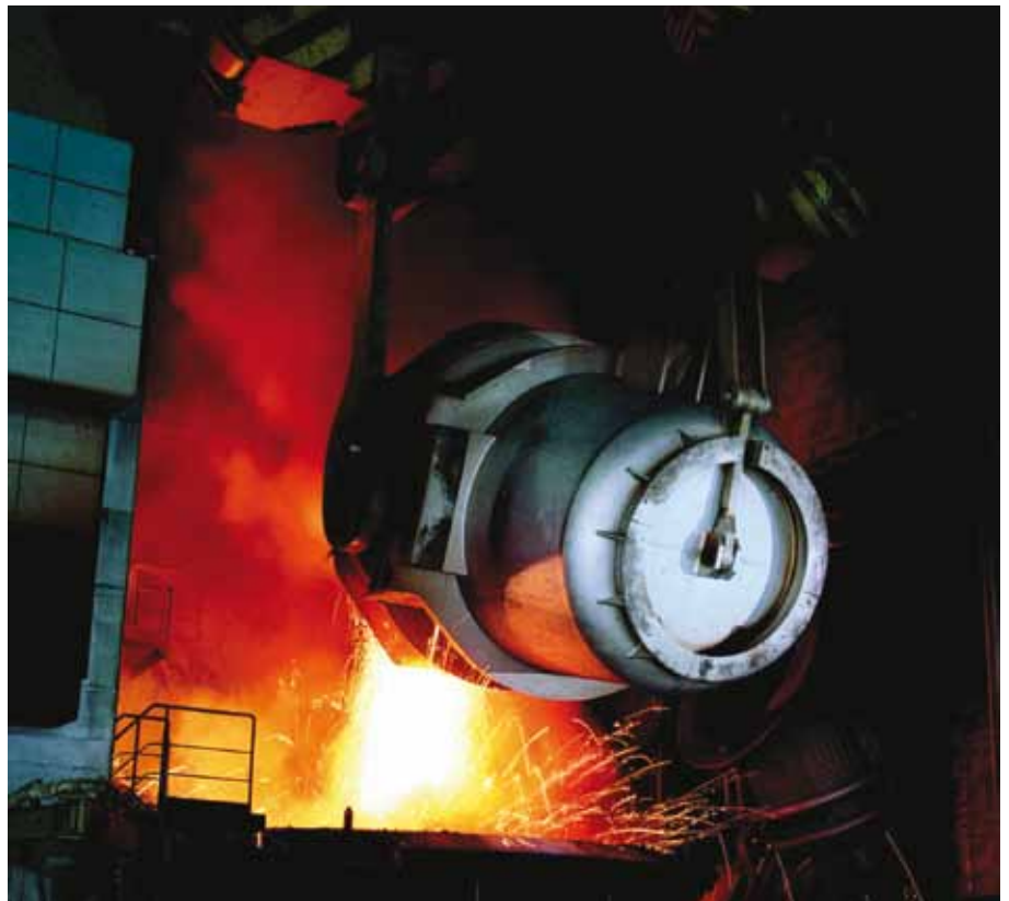
Chargieren von Flüssigstahl in einem Elektroofen
