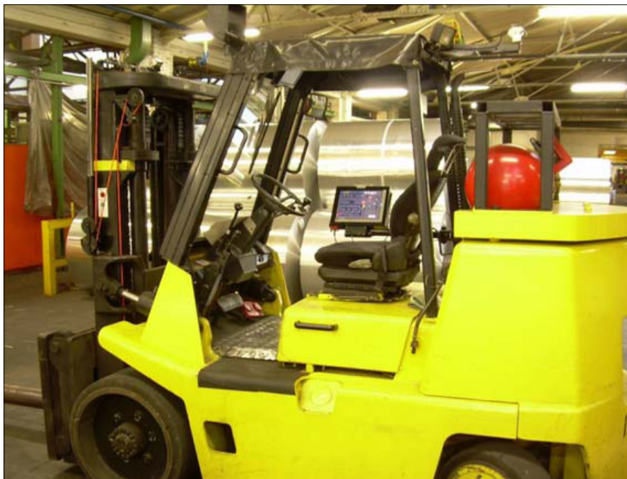
Интуитивно понятная поддержка оператора на сенсорном дисплее Источник: Hydro Гревенбройхе
