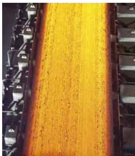
Установка непрерывной разливки слябов
