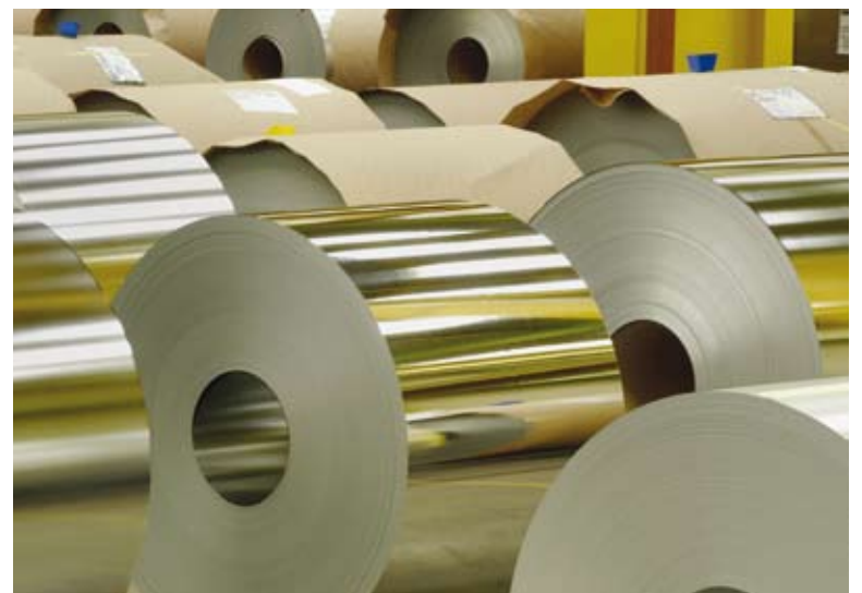
Coils - Oberflächen von matt bis hochglänzend. Die Oberfläche des Weißblechs wird dem Kundenwunsch entsprechend durch das Nachwalzen und die Art der Zinnaufgabe beeinflusst.
