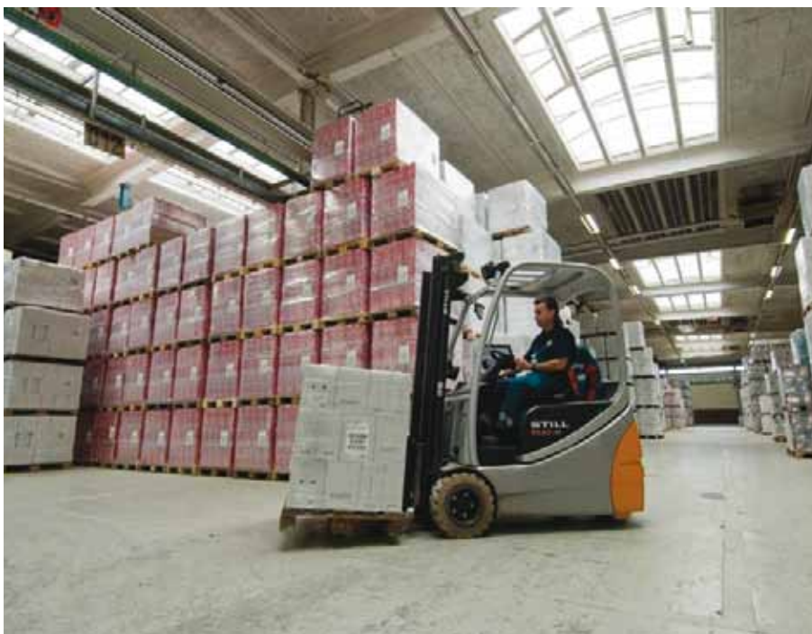
Als mobile Gates ermöglichen Stapler automatisierte Informationserfassung im Lager. Quelle: NOSTA
