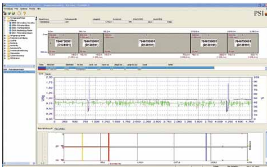
Отображение ошибок, выявленных в готовых рулонах, и значений, измеренных в рамках процессов холодной прокатки и отжига, в локальных координатах горячекатанного материнского рулона.
