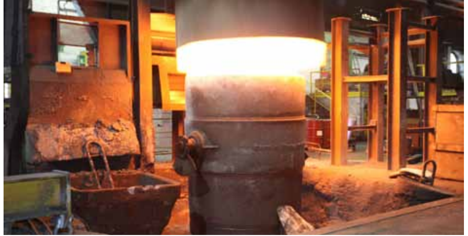
Magnesiumbehandlung mit Tauchpfanne und Tauchglocke unter effizienter Nutzung der Pfannenrestwärme aus vorherigem Prozess. Quelle: FWH
