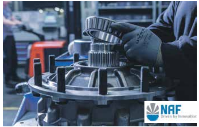
Seit über 50 Jahren kommen aus Neunkirchen am Brand in Bayern Achsen und Getriebe für die Bau-, Forst- und Landwirtschaft. (Bild 1) Montage eines Außenteils. (Bild 2)
