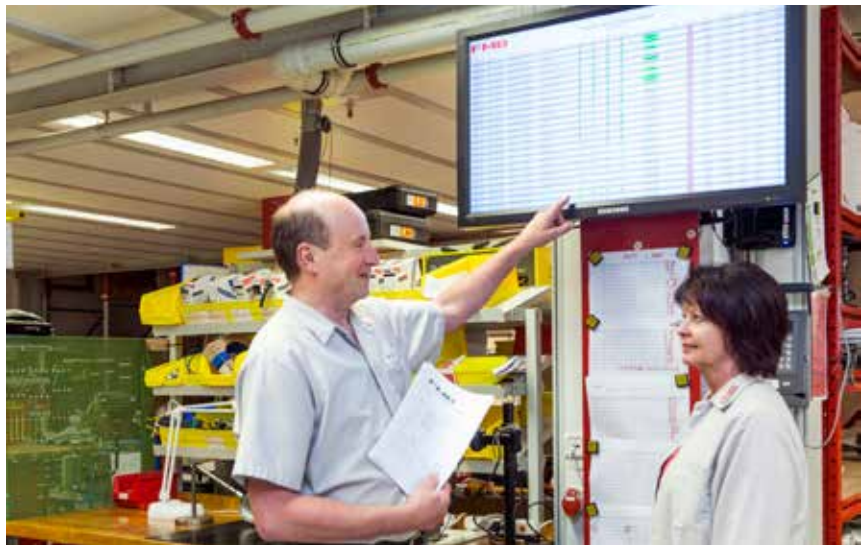
Ein Monitor zeigt die aktuelle Produktionsauslastung an und hilft dem Montageteam, die Prioritäten richtig zu setzen.
